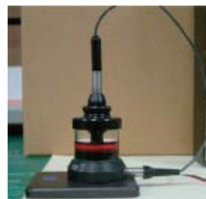
ケーブルを接続した電極
