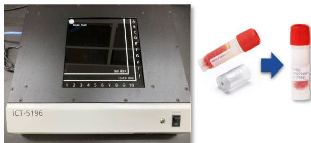
サンプル管理システムR-ISM※2のICタグリーダ(左)とマイクロバンクに装着したICマルチジャケット※3(右)。ジャケットを装着したマイクロバンクをICタグリーダで読み取り、大量のサンプル管理を行っている。
