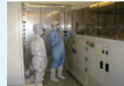
クリーンルーム UBM(無電解めっき) めっき装置クラス1000
